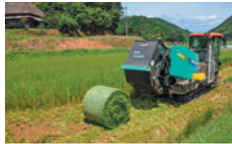
専用コンバインで刈り取った稲は300kgのロールとなって排出され、ラッピングマシンによってラップされていきます
